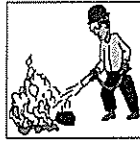
จับปลายสายฉีดให้แน่นแล้วเข้าไปที่ฐานของไฟโดยยืนอยู่ในตำแหน่ง บนมือโยก ห่างจากกองไฟประมาณ 7-8 ฟุต
